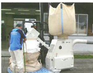
脱皮破砕機による生籾米のSGS調製試験
