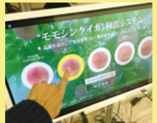
大画面タッチパネル式のオペレーションで簡単に誰でも操作することができます。過去の被害果の履歴などのデータをチェックすることも可能で、検査システムと連動して管理することができます。
